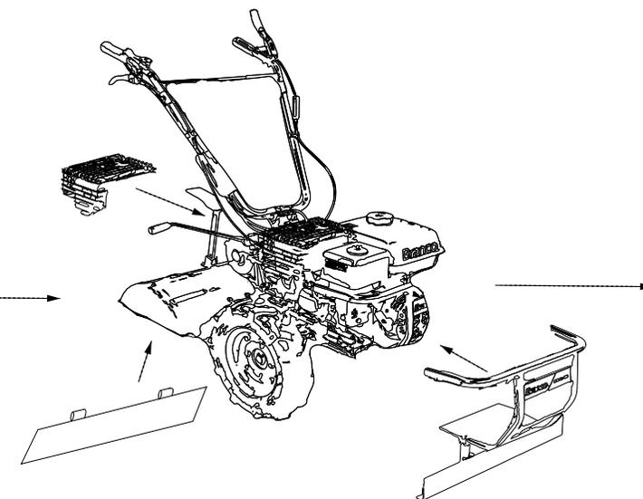
5. Monte a carenagem do motor, a grade de proteção do escapamento e a proteção metálica traseira do para-lamas.
