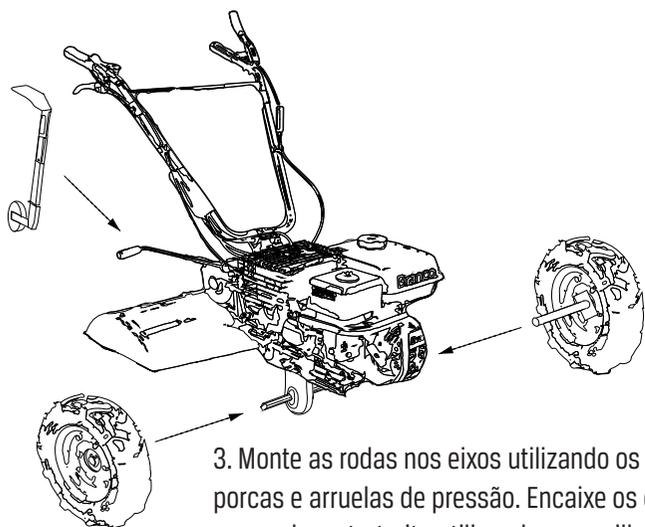
3. Monte as rodas nos eixos utilizando os parafusos, porcas e arruelas de pressão. Encaixe os eixos com roda no tratorito utilizando as cupilhas e contrapontos. Monte o contraponto traseiro utilizando uma cupilha e trava.
