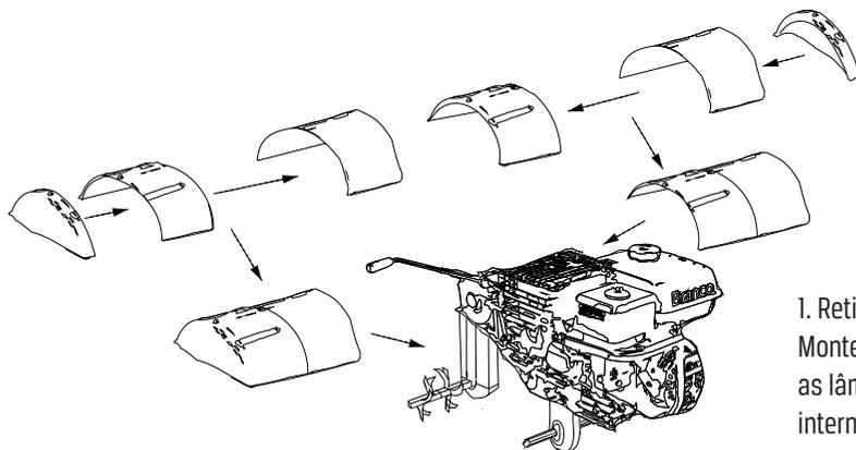
1. Retire o produto da caixa. Monte os paralamas sobre as lâminas. Inicie pelas partes internas seguindo para as externas utilizando os parafusos, porcas e arruelas de pressão.
