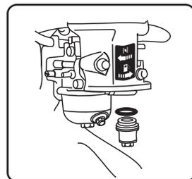
**Obs:** Alguns motores Buffalo podem estar equipados com filtro de combustível, troque-o a cada 100 horas e reinstale com a seta indicada para o sentido do fluxo do combustível.
