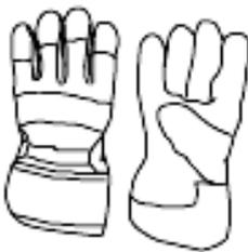
Devem ser utilizadas luvas do tipo anti-derrapante, para que o operador possa segurar firmemente o equipamento, também reduzir as vibrações do motor para o operador.
