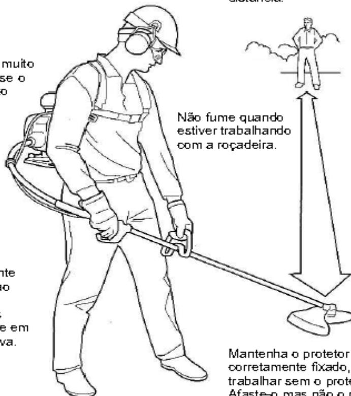
Mantenha o protetor da lâmina corretamente fixado, nunca trabalhar sem o protetor. Afaste-o mas não o retire da máquina.
