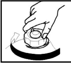
Fig. 14 – Fechamento da tampa de combustível
