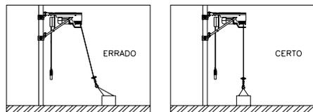
Figura 05 – Demonstração da posição inicial para elevação da carga
