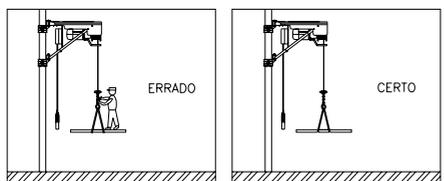
Figura 07 – Demonstração de elevação de carga com pessoas
