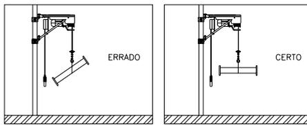
Figura 10 – Demonstração de elevação de carga desequilibrada
