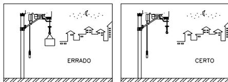
Figura 11 – Demonstração do equipamento ao término da utilização
