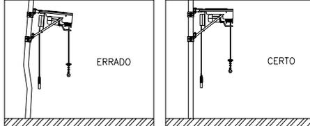
Figura 08 – Demonstração do local para fixação do equipamento
