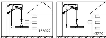
Figura 06 – Demonstração da elevação de carga sem obstáculos
