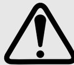
Não utilize gasolina ou qualquer solvente inflamável para limpar o filtro. A utilização desses produtos pode gerar incêndio ou explosões. Use somente água e sabão ou querosene.
