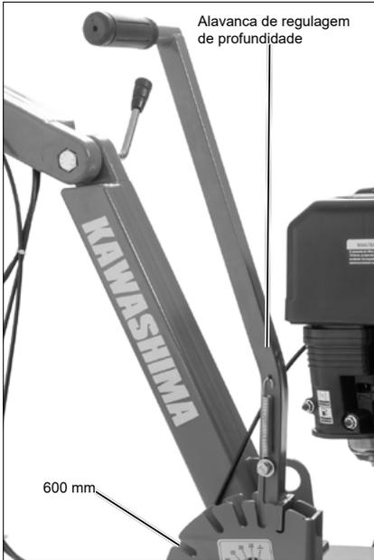
Após fazer a montagem da alavanca puxe-a para a regulagem mais profunda (600 mm), isso fará que a parte frontal do equipamento se levante, facilitando assim a montagem da roda frontal.
