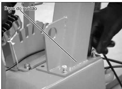
Retire a manivela da parte superior do guidão e posicione-o sobre a parte inferior.
