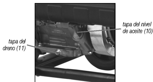
Fig. 7 – tapa del nivel de aceite (varilla)
