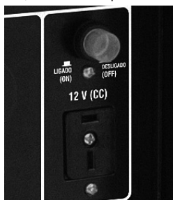
Figura 15 – Disjuntor do circuito CC
