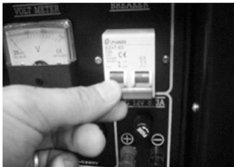
08. Após desligar o disjuntor do painel deve desligar a chave de partida (para posição OFF). Neste instante o motor irá desligar.
