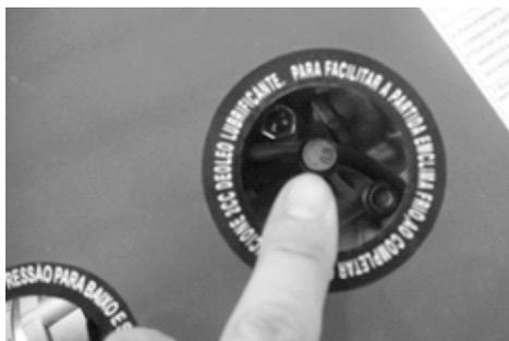
10. Para o modelo diesel 8000cle, no painel possui acionamento para aquecimento, auxiliando na partida quando em regiões frias. Pressione o interruptor (HEAT) aproximadamente 10 segundos. Em seguida efetue o procedimento para ligar o gerador.
