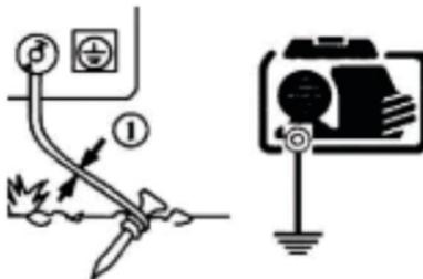
**IMPORTANTE** – Para aterramento do equipamento, utilize o fio condutor com a capacidade de corrente correto.
