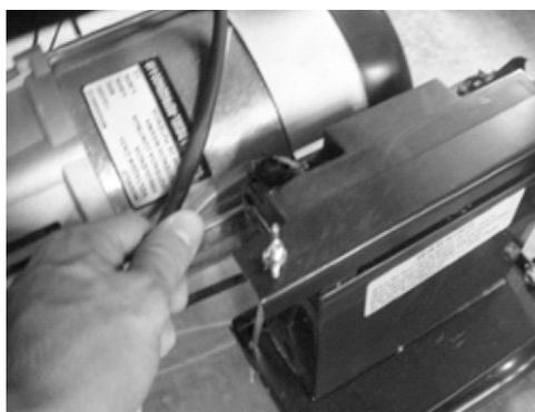
03. Verifique se o disjuntor do painel está na posição “OFF” conforme indicado, com a haste para baixo, o gerador não deve ser ligado com os aparelhos conectados, pode ocorrer à queima destes equipamentos.
