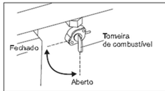
O registro do combustível se encontra entre o tanque de combustível e o carburador. Com a alavanca do registro na posição ON, o combustível irá do tanque para o carburador. Após desligar o motor leve a alavanca para a posição OFF.
