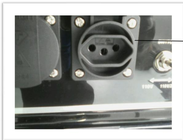
Seu equipamento vem com duas saídas de tensão 110 v, padrão ABNT, podendo ser usadas simultaneamente, obedecendo o limite de carga.
