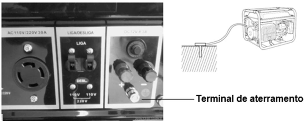
Para efetuar o aterramento utilize um fio com capacidade adequada conforme indicado:
