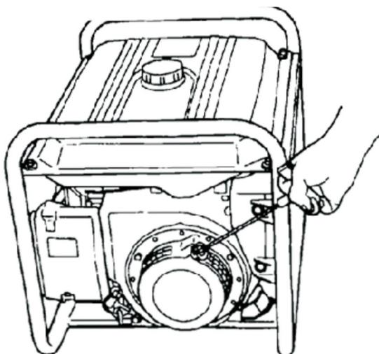
5. Após o motor aquecer, abra o afogador e posicione a alavanca para aberto.
