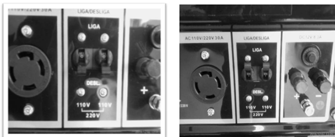
Quando o disjuntor desligar durante a operação, significa que o gerador está sobrecarregado ou existe algum problema com a utilização. Desligue o gerador imediatamente, verifique qual o problema na utilização ou qual defeito está sobrecarregando o gerador e leve-o em um assistente autorizado mais próximo.
