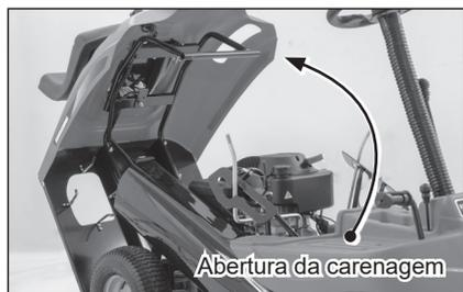
Com a carenagem levantada, retire a vareta de nível de óleo, recoloca-a sem rosquear e retire novamente. Se o nível do óleo estiver abaixo do nível máximo, complete com o óleo recomendado.
