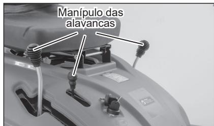
Após soltar os manípulos, levante a carenagem para ter acesso ao motor.
