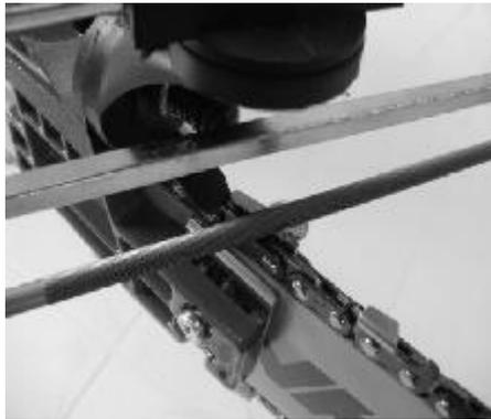
2. Depois de todos os dentes estarem afiados deve-se medir a altura do limitador de profundidade que deve ser de 0,5 mm. Para isso, utilize um calibrador e uma lima chata.
