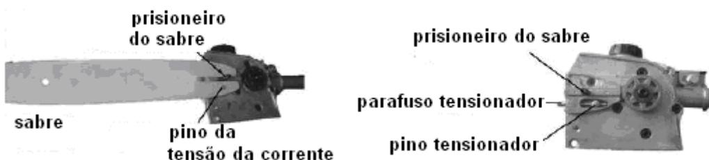
3. Instale a corrente sobre o sabre com os gumes da parte superior apontando para a ponta do sabre.
