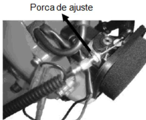
2. Ajuste a porca do cabo acelerador até obter uma folga no gatilho do acelerador e depois aperte-a contra o suporte do nípel.
