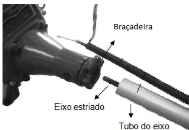
5. Alinhe os orifícios de posicionamento no tubo e braçadeira, Em seguida, instale o parafuso.
