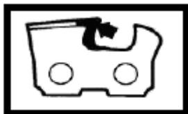
**Causa:** Aprofundar demasiadamente a lima no momento de afiação ou uso de lima inadequada.
