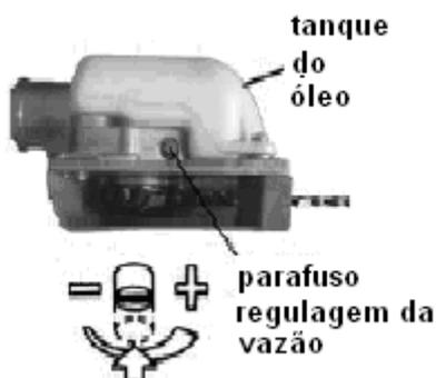
3. Com uma chave de fenda gire o parafuso de regulagem conforme mostra a figura acima:
