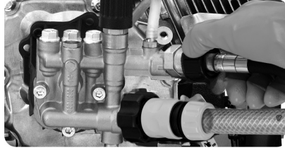
Figura 14 – Conectando la manguera de alta presión
