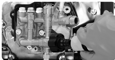
Figura 13 – Conectando a mangueira de entrada de água
