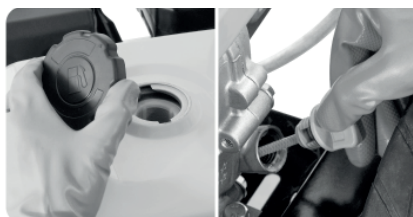
Figura 18 – Verificando o nível de óleo e gasolina
