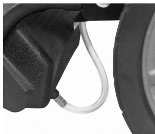
Figura 26 – Conectando la manguera del detergente en lo recipiente
