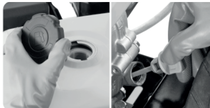
Figura 18 – Verificando el nivel de aceite y gasolina
