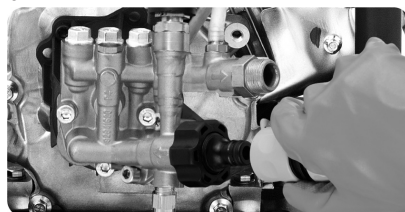
Figura 13 – Conectando la manguera de entrada de agua
