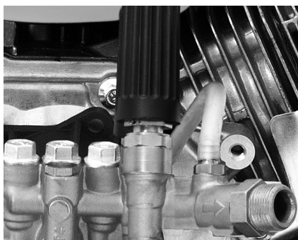
Figura 25 – Conectando la manguera de detergente en la bomba
