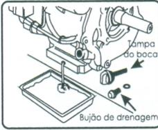
1 - Com o motor desligado, remova o bujão do dreno do cárter, permitindo a saída de todo o óleo armazenado no cárter do motor.
