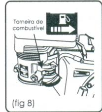
Com esse procedimento evita-se o depósito de combustível no carburador, proporcionando uma melhor partida quando for reutilizá-lo.
